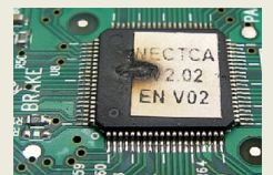
сгоревший процессор магнитолы
